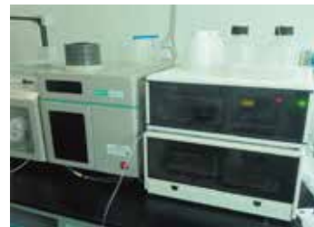
Prin-Cen 的 ELSpe-2 形态分析仪与各个厂家的原子荧光联用的实际应用案例
