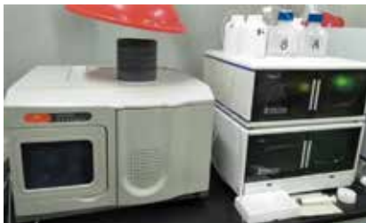
Prin-Cen 的 ELSpe-2 形态分析仪与各个厂家的原子荧光联用的实际应用案例
